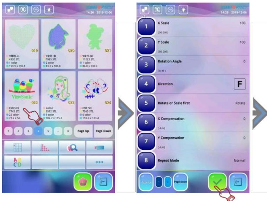
2. Viene visualizzata la finestra interfaccia impostazione parametri ricamo; se si procede seguendo i parametri predefiniti (che in generale sono quelli più precisi), premere per confermare. Per apportare modifiche premere direttamente la voce desiderata. Dopo aver modificato tutti i parametri, premere l'icona ; il sistema salverà automaticamente i parametri correnti per poi tornare alla schermata funzioni principali.
