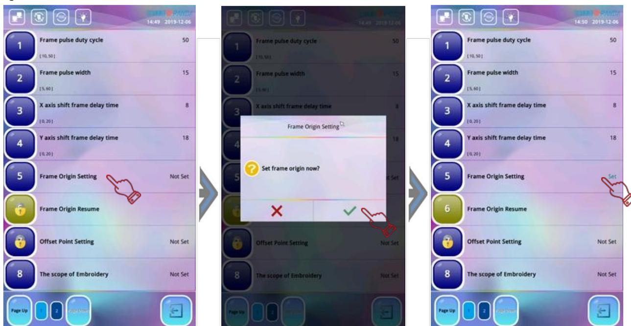
2. Passare alla seconda pagina premendo "Impostazione origine telaio"; il sistema apre la finestra di dialogo "Impostare adesso l'origine telaio?".
