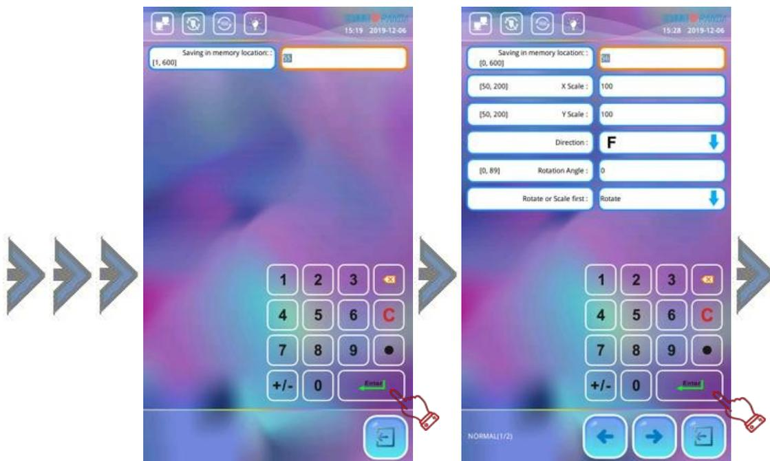
3. accedere alla seconda interfaccia modifica ricamo combinato ed inserisce il secondo numero del ricamo da combinare, impostare l'ingrandimento, la direzione di rotazione, l'angolo di rotazione, la modalità di priorità e altri parametri ricamo. Per analogia, è possibile selezionare più ricami combinati. Se il ricamo della modifica non è il primo nella combinazione, la distanza (unità: mm) del ricamo rispetto al primo deve essere impostata in base alle effettive esigenze;
