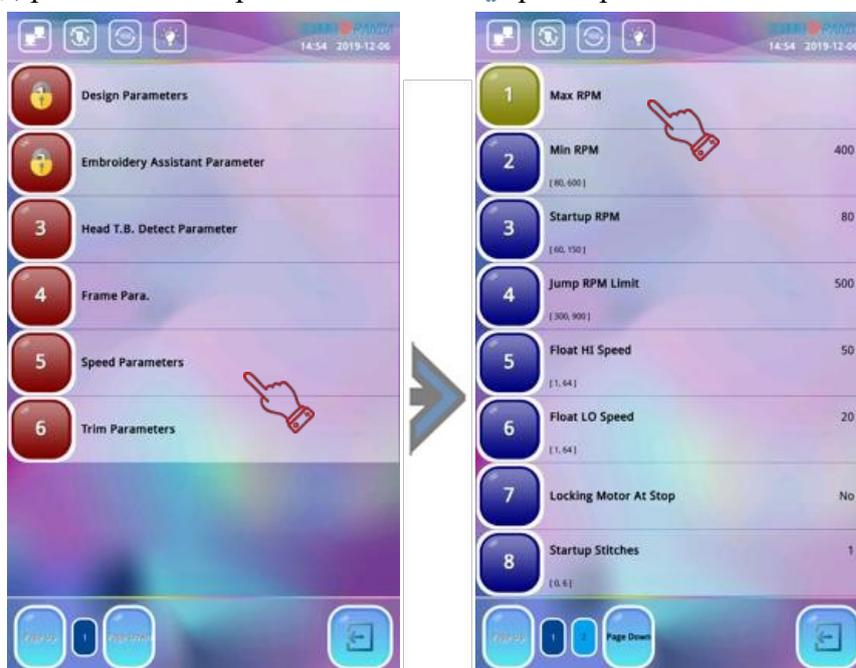
2. premere "Max RPM" o "Min RPM" in base alle esigenze per impostare la velocità di rotazione specifica.
