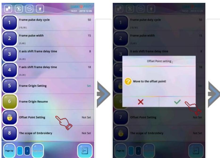
5. Dopo aver impostato il punto di offset, il sistema torna all'interfaccia precedente, "Impostazione punto di offset" visualizzando "Imposta"; si torna alla schermata funzioni principali; premere "Start" per iniziare. Il telaio si sposterà automaticamente dal punto di sfalsamento rispetto al punto iniziale del ricamo.
